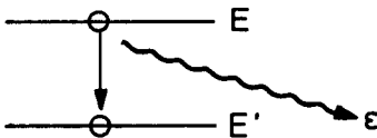
Abb. 4.2. Übergang eines angeregten Zustandes E in den Zustand E' und Emission eines Quants mit Energie \varepsilon
